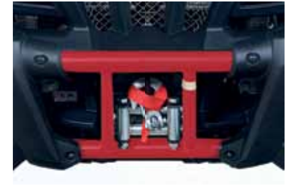
SEILWINDE 1360 KG ZUGKRAFT
